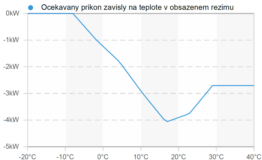
Obrázek 5.4: Graf znázorňující vliv venkovní teploty na spotřebu energie s využitím odhadnutých parametrů \beta_j^o modelu malé administrativní budovy v obsazeném režimu, kde většinu spotřeby energie tvoří elektrické vytápění. Osa x interpretuje venkovní teplotu a osa y relativní změnu spotřeby energie pro danou venkovní teplotu.
