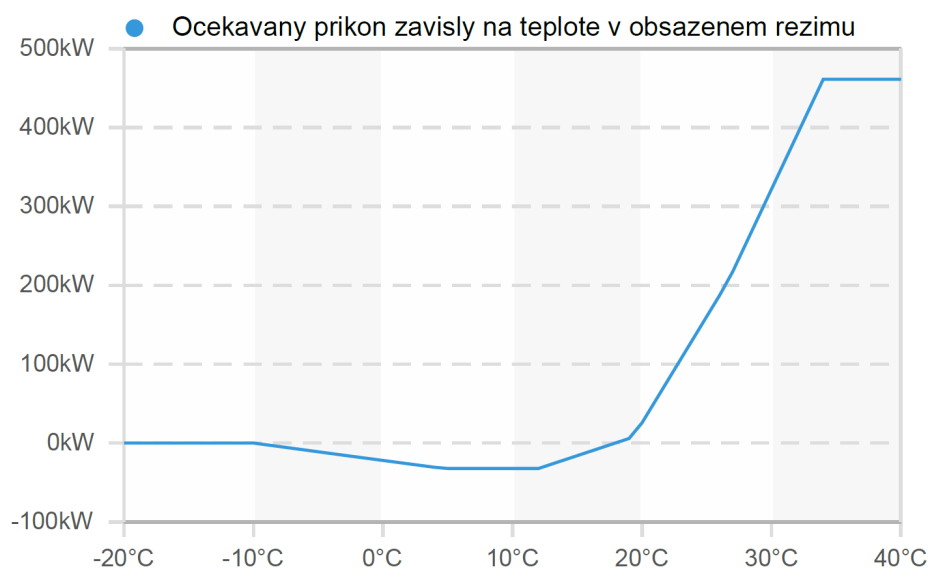
Obrázek 5.7: Graf znázorňující vliv venkovní teploty na spotřebu energie s využitím odhadnutých parametrů \beta_j^o modelu velké administrativní budovy v obsazeném režimu, kde většinu spotřeby energie tvoří chladičový výkon. Osa x interpretuje venkovní teplotu a osa y relativní změnu spotřeby energie pro danou venkovní teplotu.
