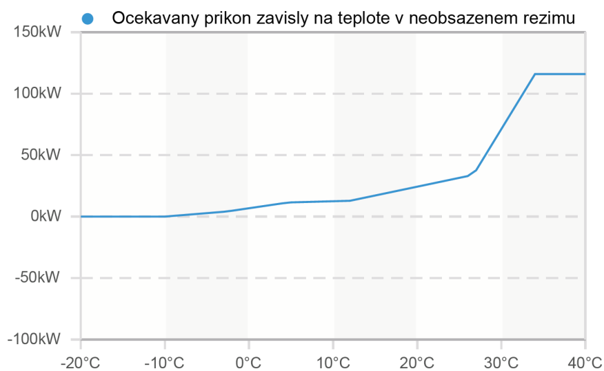
Obrázek 5.11: Graf znázorňující vliv venkovní teploty na spotřebu energie s využitím odhadnutých parametrů \beta_j^u modelu monobloku ČVUT Fakulty elektrotechnické a Fakulty strojní v neobsazeném režimu. Osa x interpretuje venkovní teplotu a osa y relativní změnu spotřeby energie pro danou venkovní teplotu.
